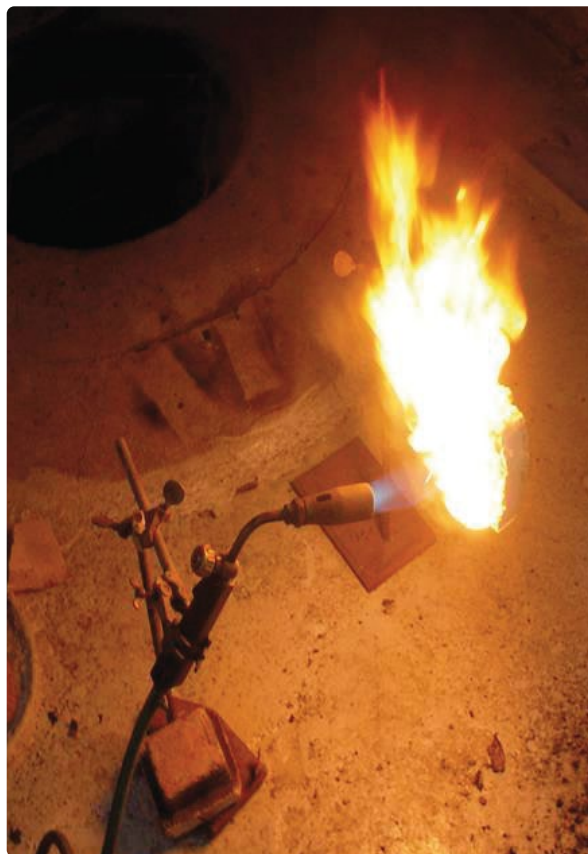
SIN RETARDADORA DEL FUEGO, GENERA LLAMAS RÁPIDAMENTE.
