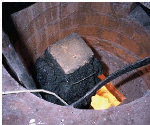
60 MINUTOS, 500^{\circ}\text{C} -F-60. SE OBSERVA EL HINCHAMIENTO DE LA PELÍCULA.
