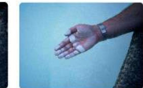
Término de la pintura de piscina por vejez natural, debido a oxidación provocada por el cloro
